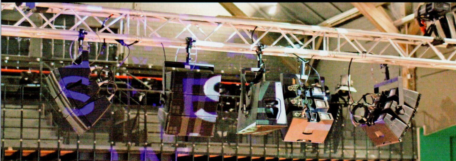
Bild 3: Die Produktion bringt die gesamte Beschallung mit; in der Raummitte hängt eine Traverse mit vier d&b Array-Tops, dazu eine „Dusche“ (Eller) für dezentes Gesangs-Monitoring
